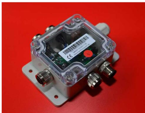
Dieser Multiporter ist nicht nur ein Verteiler mit 5 Ports, sondern ein vollständiges abgeschlossenes NMEA 2000 Netzwerk, mit variabel schaltbaren Endwiderständen, Poweranschlüssen und Statusindikatoren. Mehr dazu finden Sie in der Bedienungsanleitung zu diesem Produkt.
